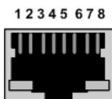
Разъемы **RJ-45** имеют на корпусе патч-панели маркировку **Xi**. Разъемы этого типа имеют 8 контактов (1..8).
