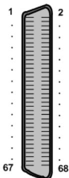
Разъемы **SCSI** имеют на корпусе патч-панели маркировку **XS0** и **XS1**. Разъемы этого типа имеют 68 контактов (1..68).
