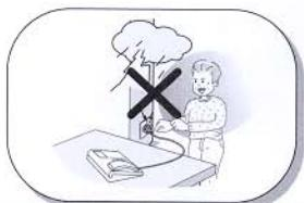
При отключении энергопотребления или телефонного шнура беритесь за вилку и аккуратно тяните её. Нельзя браться и тянуть за электрический и телефонный шнур! Это может привести к поражению электрическим током или поломке аппарата.
