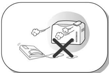
Для установки ТА выбирайте сухие помещения с хорошей вентиляцией. В противном случае это может привести к поломке ТА.
