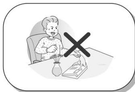
Избегайте попадания жидкости внутрь ТА. Если это произошло, немедленно отключите ТА от электрической сети и телефонной линии и поместите его в сухое место. Обратитесь в сервис-центр. В противном случае это может привести к пожару или поражению электрическим током.
