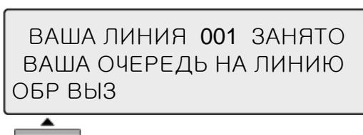
**ОБР ВЫЗ** : Если после того как Вы набрали «9» для выхода на СО линию, Вы слышите сигнал занято, это значит, что нет свободной СО линии для совершения звонка. Для постановки в очередь на получение доступа к СО линии нажмите [ОБР ВЫЗ].
