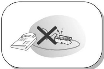
При подключении телефонного аппарата не используйте поврежденные шнуры и телефонные розетки. В противном случае это может привести к пожару или поражению электрическим током.
