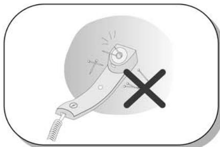
Будьте осторожны при использовании телефонной трубки, т.к. к ней могут примагничиваться иголки, булавки и др. мелкие металлические предметы, что может привести к травмам.
