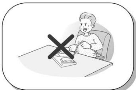
При отключении энергопотребления или телефонного шнура беритесь за вилку и аккуратно тяните её. Нельзя брать и тянуть за электрический и телефонный шнуры! Это может привести к поражению электрическим током или поломке аппарата.
