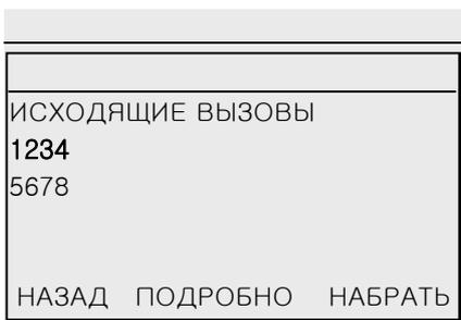
Выберите желаемый номер с помощью Клавиши навигации
