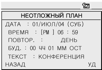
Для просмотра наступившего события (неотложного плана) нажмите Неотложный план – последний план, в котором сработало звуковое напоминание.
