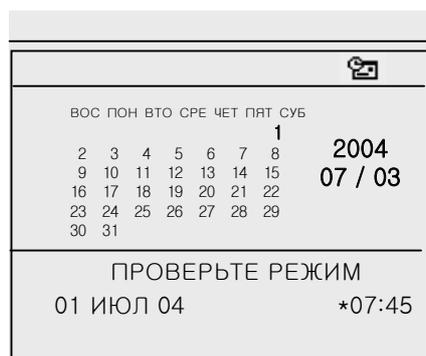
Когда текущее время совпадает с установленным временем напоминания события плана в верхней части дисплея отображается соответствующий символ и раздается звуковой сигнал.
