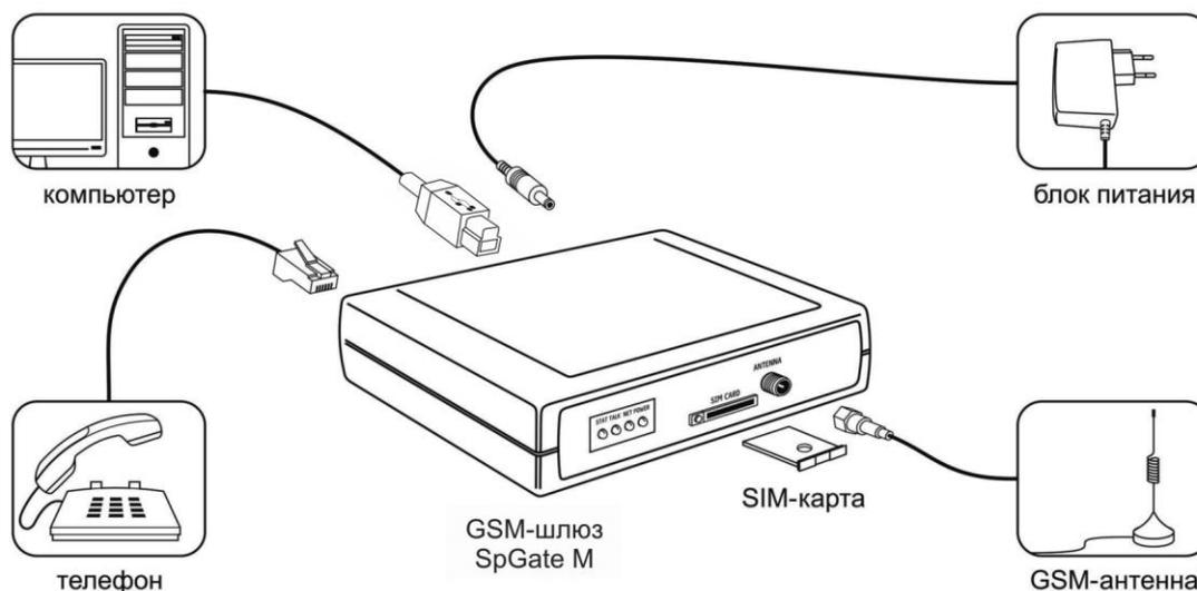
Рис 6.1 Подключение шлюза SpGate M
